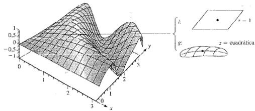
Figura 3.2.1. Las aproximaciones lineal y cuadrática a  $z = \text{sen}(xy)$  cerca de  $(1, \pi/2)$ .
